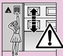
**Les appareils de commande fixes (par exemple boutons-poussoirs) doivent être placés en vue de la porte, mais à distance des pièces mobiles et à une hauteur minimale de 1,5 m.
