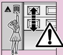
**Vaste bedieningselementen (zoals drukknoppen) moeten in het zicht van de deur worden gemonteerd, maar weg van de bewegende delen en op een hoogte van minstens 1,5 meter. Zij moeten absoluut buiten het bereik van kinderen worden aangebracht!**
