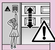
**Festinstallierte Steuerungsgeräte (wie Taster etc.), sind in der Sichtweite des Tores zu montieren, aber entfernt von sich bewegenden Teilen und in einer Höhe von mindestens 1,5 m.
